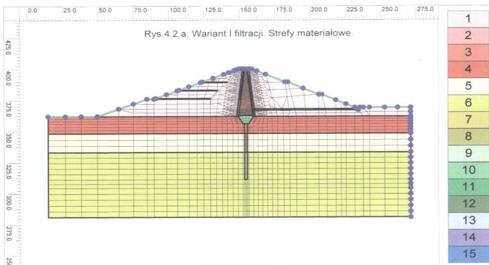
**Fig.12. Seepage simulation**
